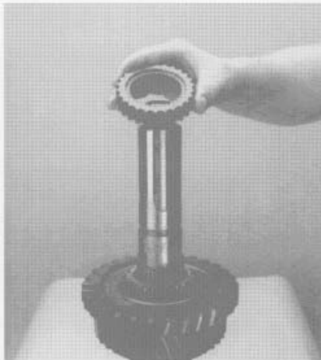
22. Remove the shift hub.
