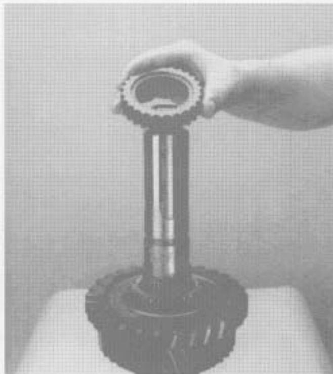
22. Remove the shift hub.
